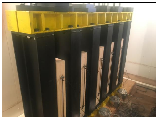
Image 1 : Illustration du dispositif expérimental pour les essais de fluage en compression
